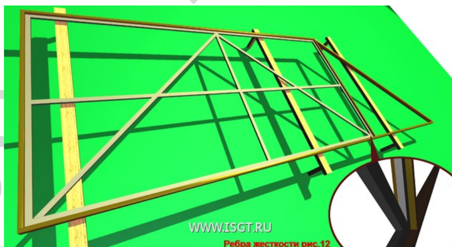
На рис. 12 показан монтажный стол и соединения ребер жесткости полотна откатных ворот
