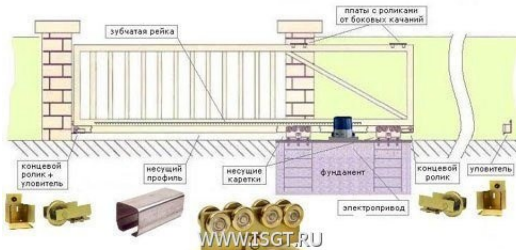
расположение основных элементов конструкции ворот рис 3.1
