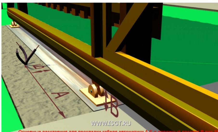
Основные расстояния для прокладки кабеля автоматики А,Б и дорожный просвет В рис.18
