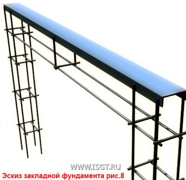
На рис. 8 показан эскиз закладного элемента откатных ворот
